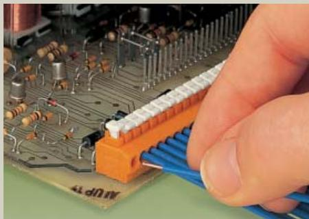
Подключение проводников с использованием нажимной кнопки
