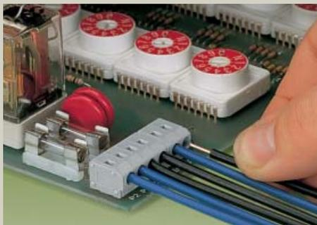
Подключение проводников без использования нажимной кнопки
