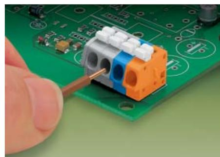
Подключение одножильного проводника:
