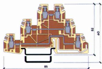
**Клемма винтовая проходная трехъярусная**
