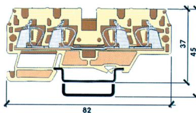
**Клемма пружинная проходная (2 входа + 2 выхода)**
