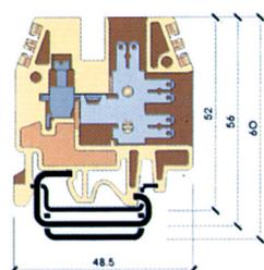
Клемма для быстрого соединения с помощью наконечников с "язычком" 6,3x0,8 мм или 2,8x0,8 мм
