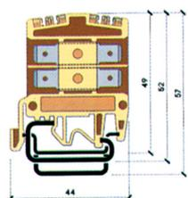
Клемма для быстрого соединения с помощью наконечников с "язычком" 6,3x0,8 мм
