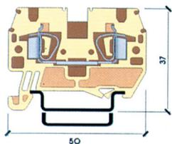
**Клемма пружинная проходная**
