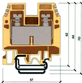
**Клемма винтовая проходная\***
