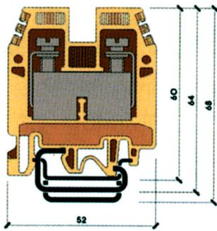
**Клемма винтовая проходная**
