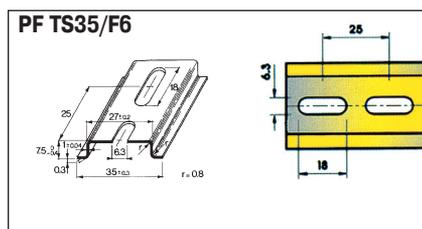
DIN-рейка перфорированная с защитным покрытием
