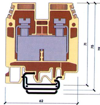
**Клемма винтовая проходная**
