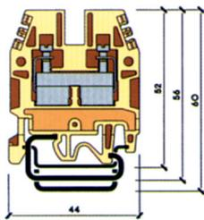
**Клемма винтовая проходная**
