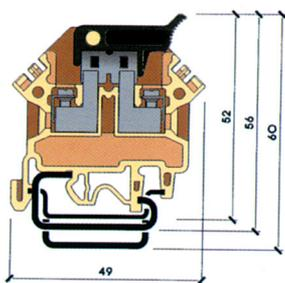
Клемма винтовая с ножевым разъединителем
