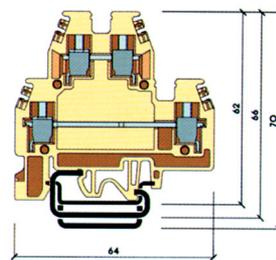
**Клемма винтовая проходная двухъярусная**
