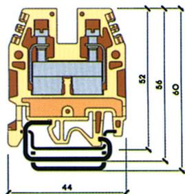
**Клемма винтовая проходная**
