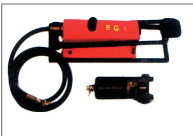
Пресс (насос + головка) маслодинамический для опрессовки наконечников 35-630 мм<sup>2</sup> (без матриц) Давление 700 бар
