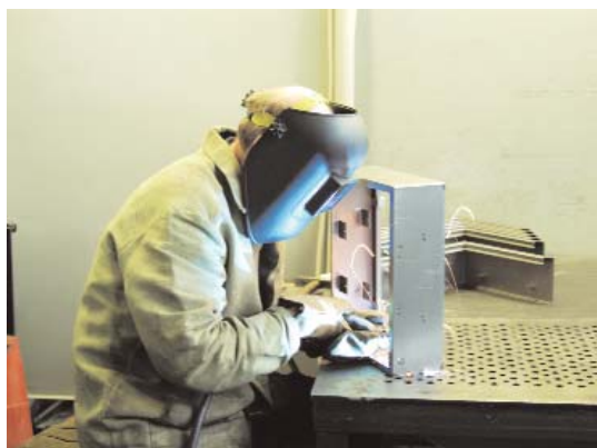
Сварка в среде защитных газов позволяет добиться максимального качества сварных швов.
