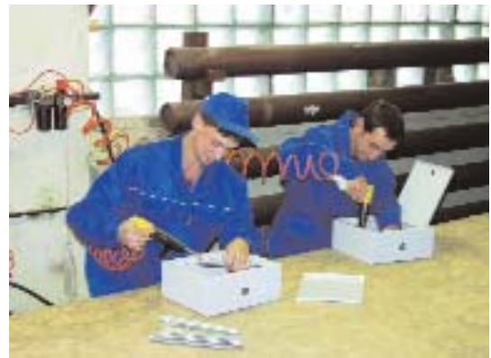
Современные пневматические шурупверты максимально ускоряют процесс окончательной сборки корпусов.
