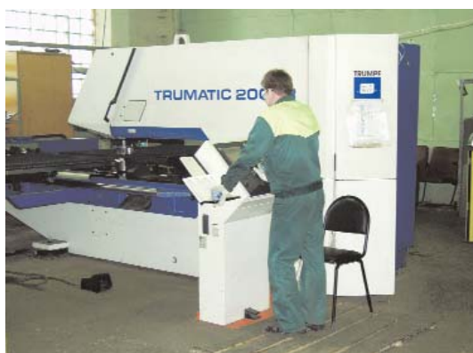
Листопробивной пресс с ЧПУ TRUMATIC фирмы TRUMPF позволяет оптимально раскрыть металлический лист с точностью до 0,1 мм.
