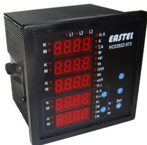
Цифровые индикаторы HCD 292Z — электронные приборы, разработанные для измерения всех параметров низковольтных и высоковольтных электрических сетей (кроме гармоник). Измеряемые параметры отображаются на пяти дисплеях. Приборы могут измерять более чем 60 параметров 3х-фазных и 4х-фазных электрических сетей, при этом характеристики измерения и отображения могут программироваться. Встроенные счетчики активной/реактивной энергии в две стороны, передача данных по RS485.
