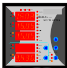
Рисунок 7: Нагрузочное значение тока (если горит индикатора, отображается нагрузочное значение тока каждой фазы)
