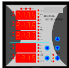
Рисунок 6: Минимальный ток каждой фазы (если горит индикатор VL-N или \Sigma A , отображается минимум напряжения или общего тока, если горит индикатор H, отображается максимум)
